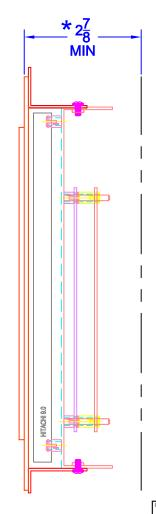
\* CLEARANCE REQUIRED FOR ELECTRONIC COMPONENTS AND CONNECTORS
