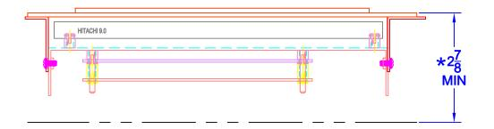
\* CLEARANCE REQUIRED FOR ELECTRONIC COMPONENTS AND CONNECTORS
